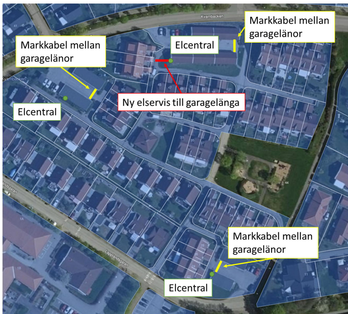
Figur 3. Översikt över markarbeten.
